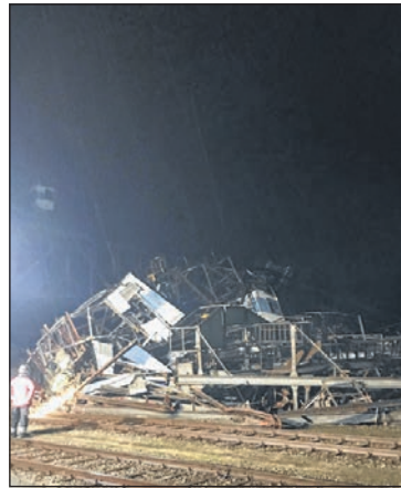
Der 400 Tonnen schwere Brückenkran, Baujahr 1940, wurde durch das starke Gewitter zum Einsturz gebracht.
