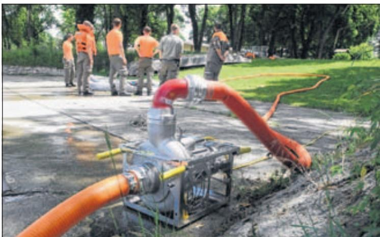
*Übung macht den Meister. Die Pioniere des Unterstützungszuges üben die Inbetriebnahme der neuen Schmutzwasserpumpe. Sie schafft bis zu 1800 Liter pro Minute und kann Schlamm und sogar kleine Steine bis zu einem Durchmesser von 8 cm fördern!*
