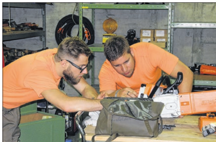
Die sorgfältige Wartung der Gerätschaften nach einer Übung ist wichtig, denn der nächste Einsatz kommt bestimmt. Im Bild: Reparatur einer Motorkettensäge durch die Materialwarte des Zivilschutzes.
